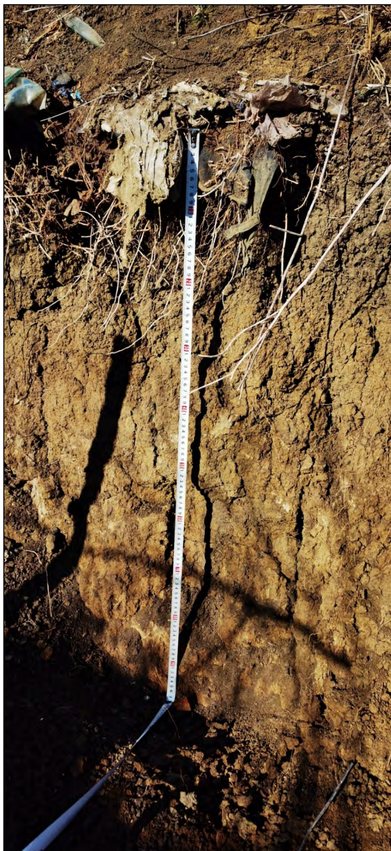
Рисунок 6.6.8 – Профиль артиурбистрата на погребенном чернозёме (разрез № Т.10)
