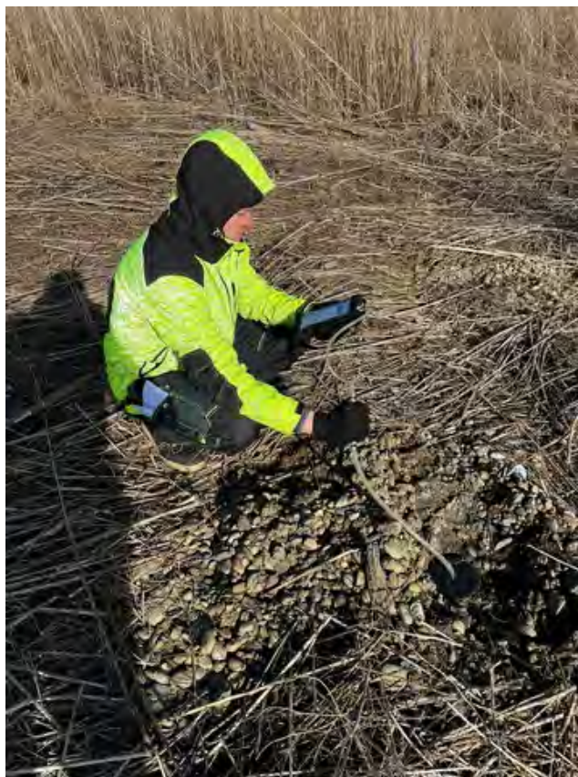
Рисунок 5.4 – Газогеохимические измерения в шпурах
